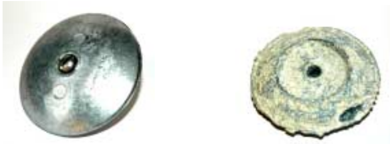
Anode plate pour installation sur gouvernail ou stabilisateur, état neuf et usée.
