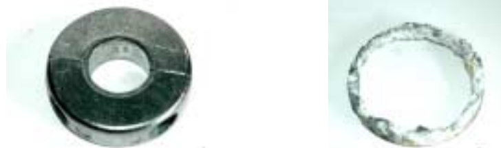
Anode cylindrique en deux parties pour montage sur un axe dans l'état neuf et avec une usure extrême.
