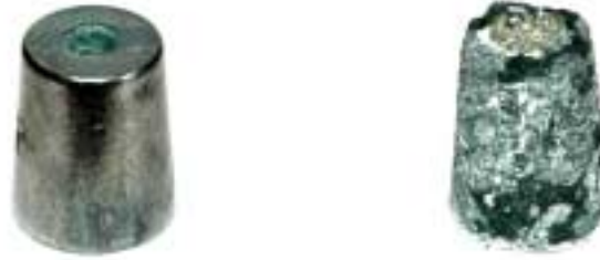
Anode conique pour montage sur axe dans l'état neuf et usée.
