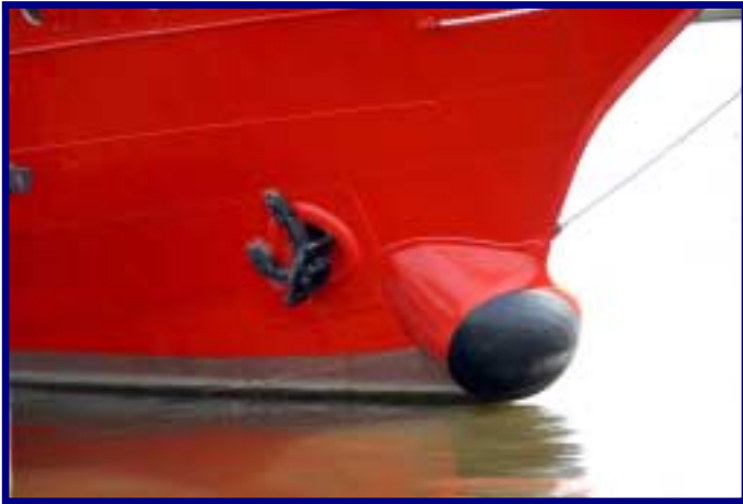
La fameuse ancre champignon de 3 tonnes sur la pointe de la proue.
