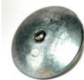
Telleranode für Montage auf Ruder oder Stabilisator, neu und abgenutzt.
