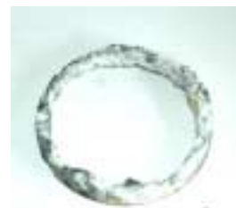
Zylindrische Wellenanode zweigeteilt in neuem und extrem abgenutzten Zustand.
