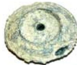
Telleranode für Montage auf Ruder oder Stabilisator, neu und abgenutzt.
