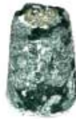
Konische Wellenanode in neuem und abgenutztem Zustand
